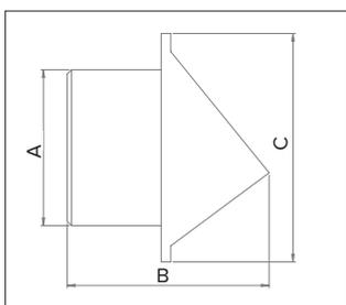
Griglia di espulsione in polipropilene bianca con serranda a gravità e copertura parapiooggia.
