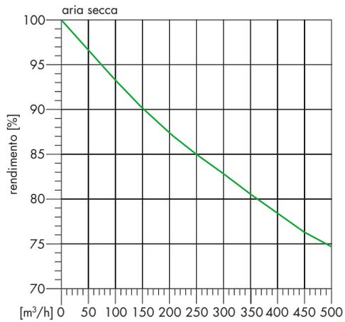
EFFICIENZA IN FUNZIONE DEL CALORE DI CONDENSAZIONE
