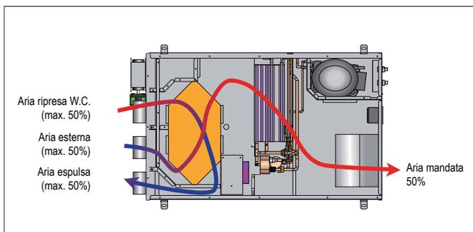
N.B. In modalità estiva l'apparecchio non può operare senza l'ausilio dell'acqua fredda e/o calda. Nel caso di portata acqua scarsa o assente l'unità viene spenta e vengono attivati i dispositivi di sicurezza.
